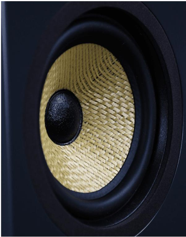
En son centre, en lieu et place d' une ogive, le concepteur a opté pour un cache noyau inerte qui a pour objectif d' aérer et de refroidir le moteur du haut-parleur. Cette technologie aboutit à favoriser les fréquences les plus basses tout en diminuant sensiblement la distorsion.
