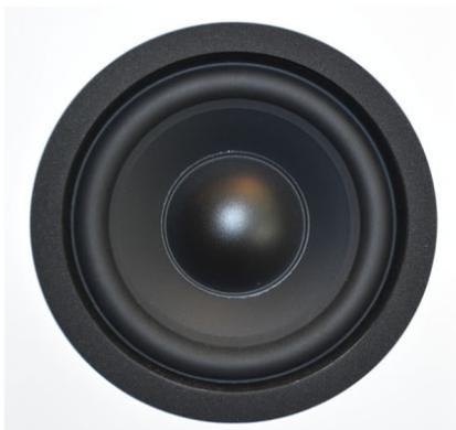
Le haut-parleur de grave, tout nouveau lui aussi, est un modèle de 13 centimètres de diamètre à membrane légère en pulpe de cellulose traitée à l' arrière pour les rendre un peu plus lourdes et bien plus rigides pour faciliter l' écoulement d' air. Ce haut-parleur est muni d' une bobine de 25 millimètres de diamètre. Le choix d' une bobine de petit diamètre a l' avantage d' avoir une capacité de réaction rapide.
