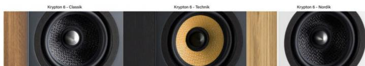
Les fréquences médium sont confiées à un haut-parleur à membrane Kevlar tressé et amorti d' un diamètre de 13 centimètres. Il a deux particularités : la première est la présence d' une ogive de dispersion en aluminium usiné pour favoriser les détails et l' ouverture, et la seconde est la couleur jaune ou noire du transducteur et de l' ogive selon les versions et finitions des ébénisteries. Il s' agit d' une petite coquetterie pas déplaisante du tout.
